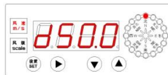
图五: 风速测量范围设置
