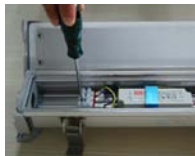
3.将电源线从防水接头插入, 接在对应的端子上, 参照接线示意图;
