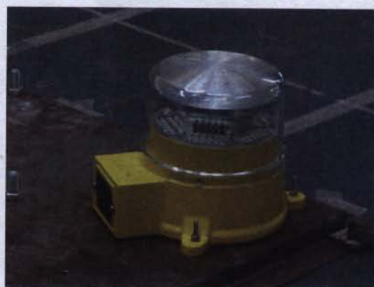
图4 安装在 TJ-2 风洞底板上的 ABC-7M 中光强航空示警灯
