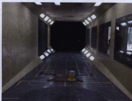
图5 安装在 TJ-2 风洞底板上的 LM101 中光强航空障碍灯
