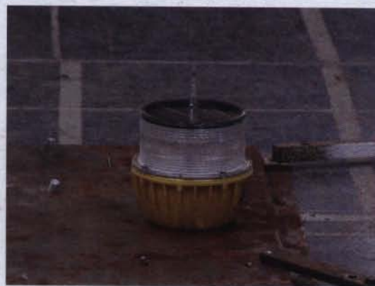
图6 安装在 TJ-2 风洞底板上的 LT101 太阳能航空示警灯
