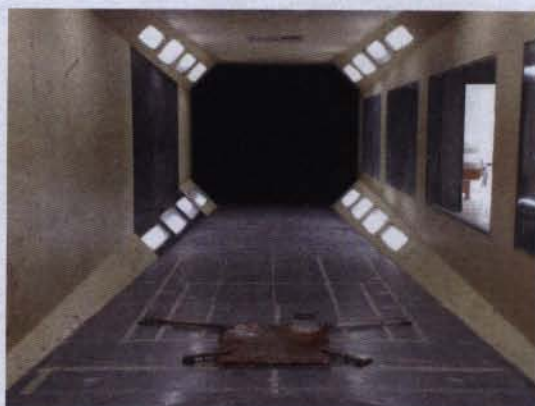
图6 安装在 TJ-2 风洞底板上的 LT101 太阳能航空示警灯
