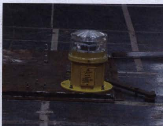
图5 安装在 TJ-2 风洞底板上的 LM101 中光强航空障碍灯
