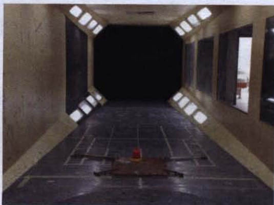
图3 安装在 TJ-2 风洞底板上的 LS708 LED 航空示警灯
