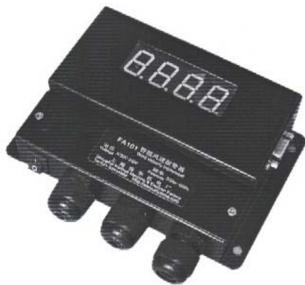
图2 FA101 智能风速报警器
